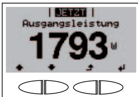
Anschließend an die Startup-Phase nimmt der Wechselrichter den Netz-Einspeisebetrieb auf.
