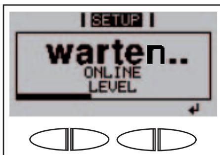
Bei abgeschlossener Software-Aktualisierung wechselt der Wechselrichter in die Startup-Phase:
