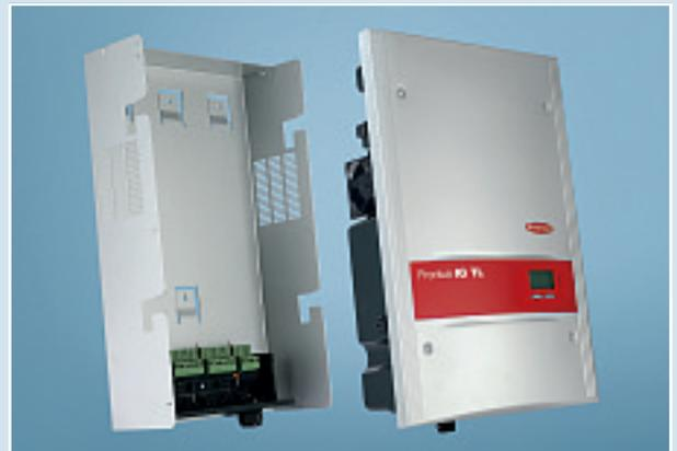
**Absolut hitze- und staubfreies Lüftungskonzept.** Durch das überlegte Lüftungskonzept ist eine Überhitzung oder Verschmutzung ausgeschlossen. Der Gerätekörper ist hermetisch abgeschottet, nur die Kühlrippen für die Elektronik liegen außen. Sie werden vom Luftstrom gekühlt, der durch den temperaturgesteuerten Ventilator an der Außenseite nach Bedarf angesaugt wird. Dadurch bleibt das Geräteinnere deutlich kühler und es findet absolut kein Austausch zwischen Innen- und Außenluft statt.
