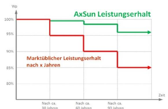
Unser Modul konnte nach allen 3 Zyklen die IEC Leistungskriterien vollstens erfüllen. Die minimale Leistungseinbußen sind weit im geforderten Bereich. Die Sichtprüfung ergab außer einer leichten Verfärbung an einem Lötverbinder keinerlei Auffälligkeiten.
